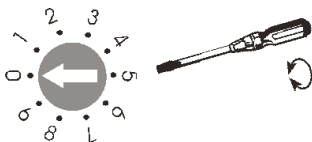
Abb.: Einstellen des Funkkanals.
